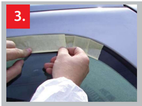
3. Um einen geraden Abschnitt abzuleben, ein maximal 20 cm langes Stück Klebeband abreißen, einstecken, umklappen und sicherstellen, dass es mit dem letzten angrenzenden Stück überlappt.
