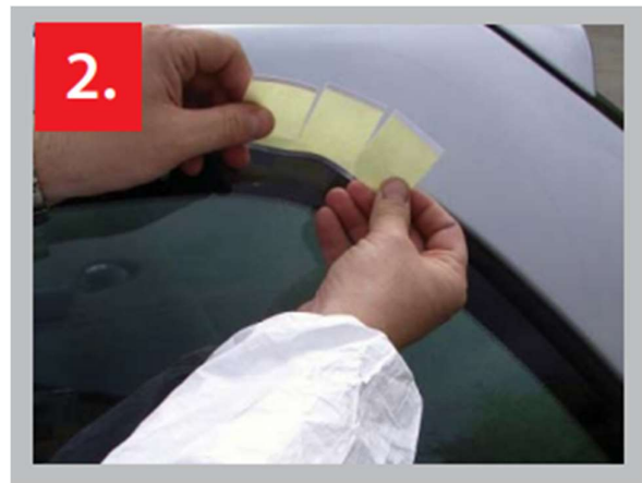
2. Um enge Ecken und Kurven abzuleben, das Klebeband mit Hilfe der Perforation in passend großen Teilstücken bis zum Plastikstreifen einreißen und zwischen Gummileiste und Karosserie schieben.
