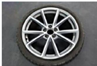
2. Reinigen Sie die Felge und stellen Sie sicher, dass sie frei von Schmutz und Fett ist.
