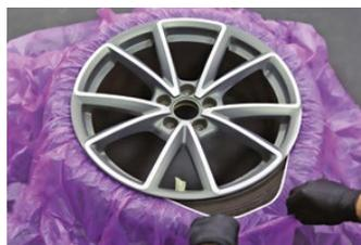
4. Drehen Sie das Rad vorsichtig um, so dass es zum Boden zeigt, ziehen Sie die Enden des Produktes zusammen und fixieren diese mit Klebeband.
