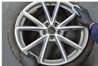
3. Ziehen Sie das Cover mit der behandelten Seite nach oben über den Reifen, in dem Sie das elastische Band zwischen Reifen und Felge platzieren.
