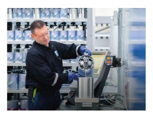
Axalta può fornirti il pacchetto completo di attrezzature per realizzare la tua sala di miscelazione. L'Alphamix è un tipico tintometro di miscelazione manuale disponibile in diverse configurazioni, in termini di numero di ripiani e dimensione delle latte.
